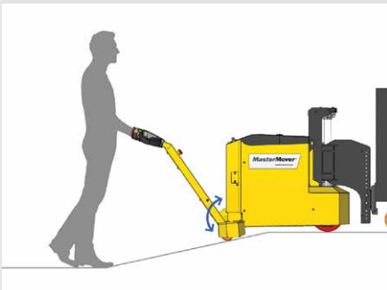
Protection des roues pivotantes
